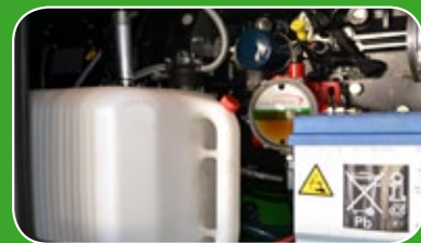
3 Tank mit destilliertem Wasser
