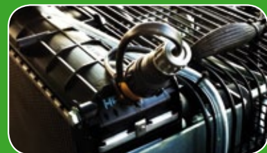
9 Kühlmittel-Sensor im Kühler
